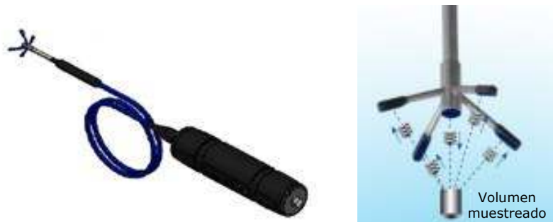
Figura III-11 Vectrino (izquierda) y su funcionamiento (derecha)
