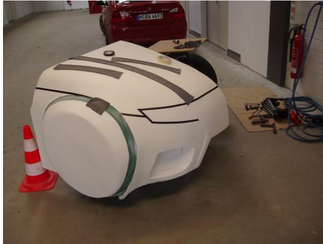
Figura 113. Banda elástica (verde) simulando los polímeros electroactivos
