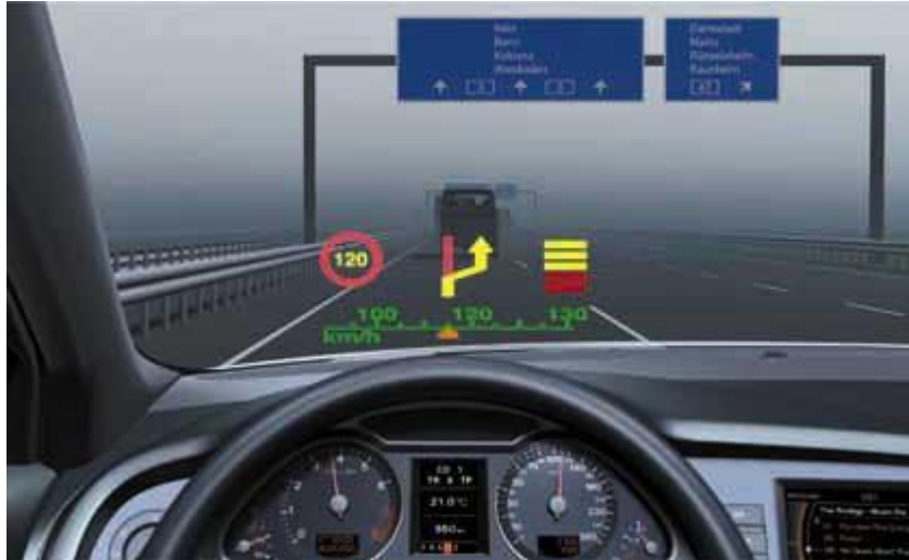
Figura 21. Instrumentos desplegados en el parabrisas (24)
