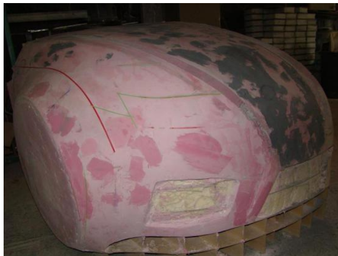
Figura 110. Molde listo para fibra de vidrio
