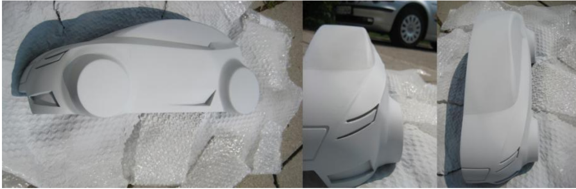
Figura 106. Superficie lista y pintura base
