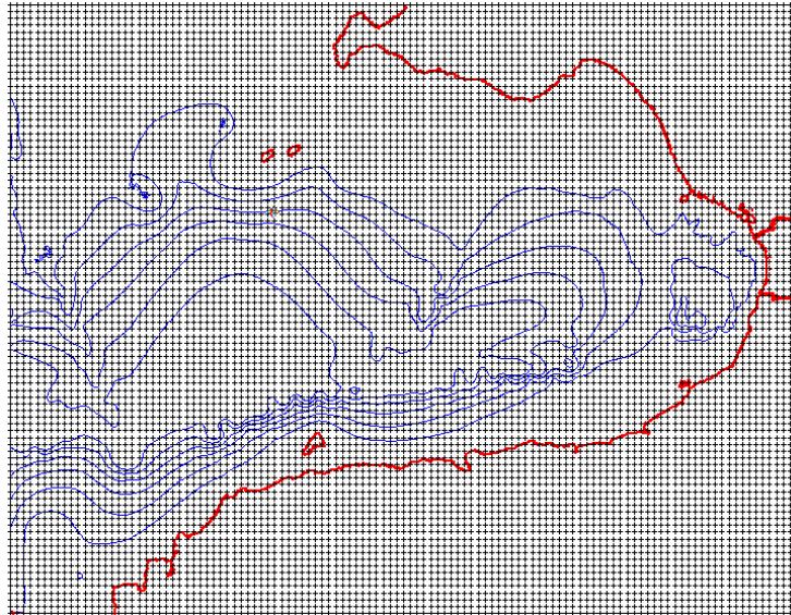
Figura 1.4. Ejemplo de batimetría y malla regular
