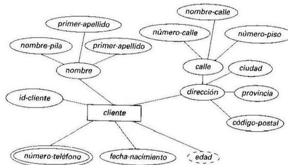
Figura 6. Diagrama E-R con atributos compuestos, multivalorados y derivados.
