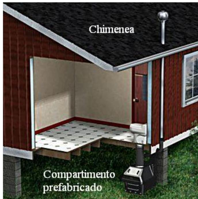
*Fig 3.17 Baño seco prefabricado*
