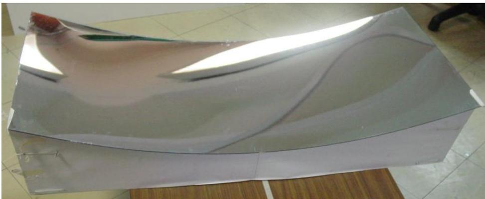
Figura 4.6 Prototipo con costillas de *foamboard* y espejo de acrílico
