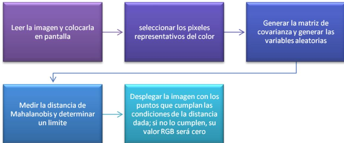
Figura4.13 Diagrama de bloques usando la distancia de Mahalanobis con Matlab
