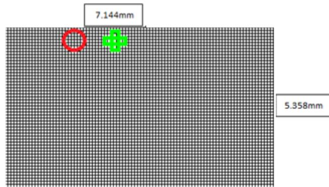
Figura 4.1 Estructura de arreglo de sensores individuales en el CCD
