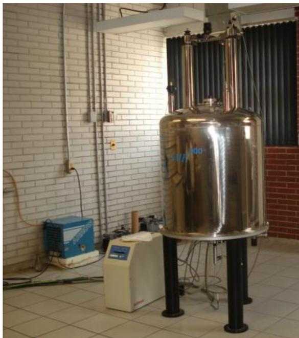
Foto 4. Espectrómetro de Resonancia Magnética Nuclear Jeol 300 MHz.
