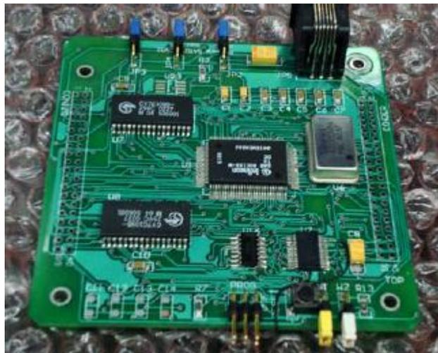
**Figura 1.8** Subsistema de Computadora de Vuelo.
