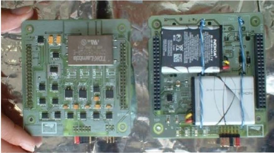
**Figura 1.5** Subsistema de Potencia.
