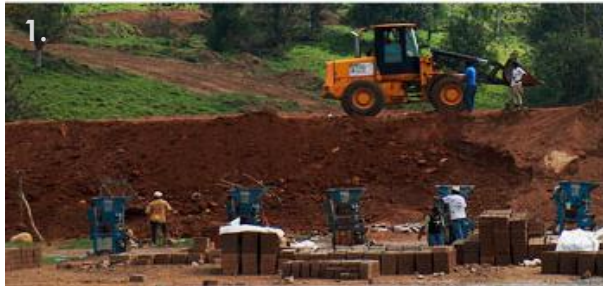
Las Imágenes 1 y 2 muestran como la comunidad se puede organizar para hacer realidad la posibilidad de una vivienda por medio de una asesoría para producir las viviendas, utilizando el material de la zona y convirtiéndolo en bloques por medio de una maquina. En la Foto3 es tomada en Nuevo Juan del Grijalva en la zona donde están haciendo movimientos de tierra para la segunda etapa. Fuente la Autora. Nov. 2010. Fuente de las imágenes 1 y 2: Échale a tu casa para uso didáctico.
