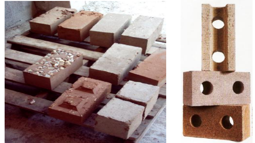
Imagen de diferentes tipos de Bloques Comprimidos de Tierra. Mostrando así la diversidad y creatividad en la utilización de la Tierra como material Constructivo Sustentable.
