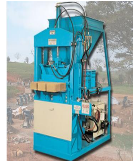
Maquina Adopress para producir el Adoblock. Fuente: Échale a tu casa- Ital Mexicana.
