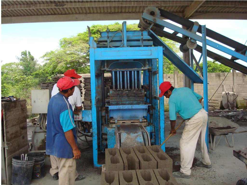
Imagen 10. Trabajadores terminando el proceso de moldeado
