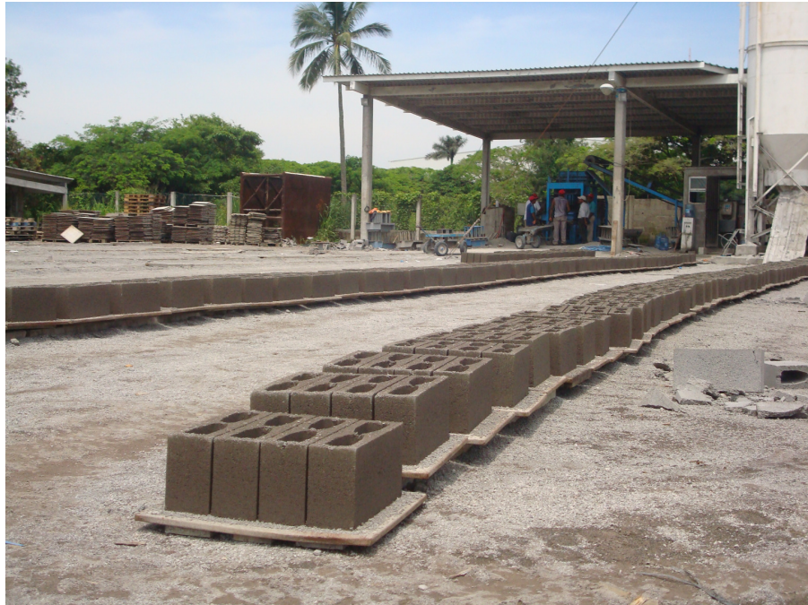
Imagen 6. Producción de block en el proceso de curado
