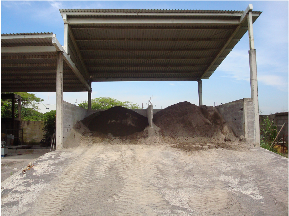
Imagen 12. Agregados polvo de piedra y arena
