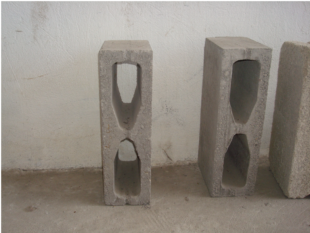
Imagen 4. Block hueco de concreto de 12x20x40 cm.
