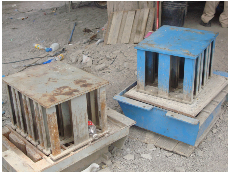
Imagen 5. Distintos tipos de moldes de acero para bloques huecos
