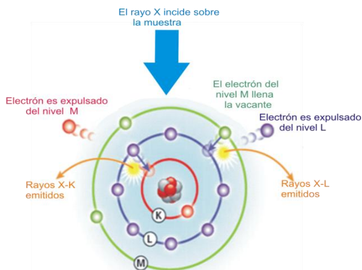
Figura 9. Esquema del momento cuando un rayo X incide sobre la muestra y afecta a los electrones más cercanos al núcleo. Tomada y modificada del Manual del Curso de capacitación del Niton XL3t 900 GOLDD.
