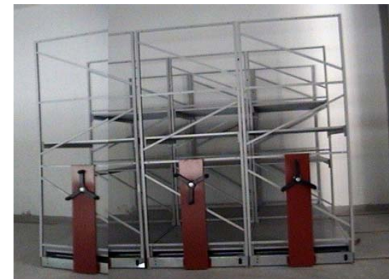
Equipada con anaqueles modulares de 1.20 x 8.00m. para el resguardo de objetos en volumen, se desplazan a través de rieles metálicos al girar un volantín, para dejar un pasillo transitable. Figura 42.
