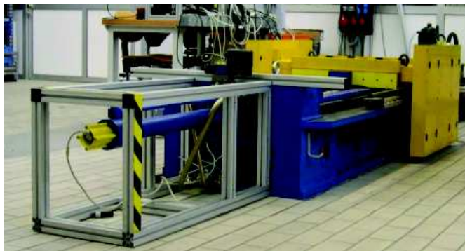
Figura 1: Equipo hidráulico experimental para pruebas de algoritmos de control por modos deslizantes [10]
