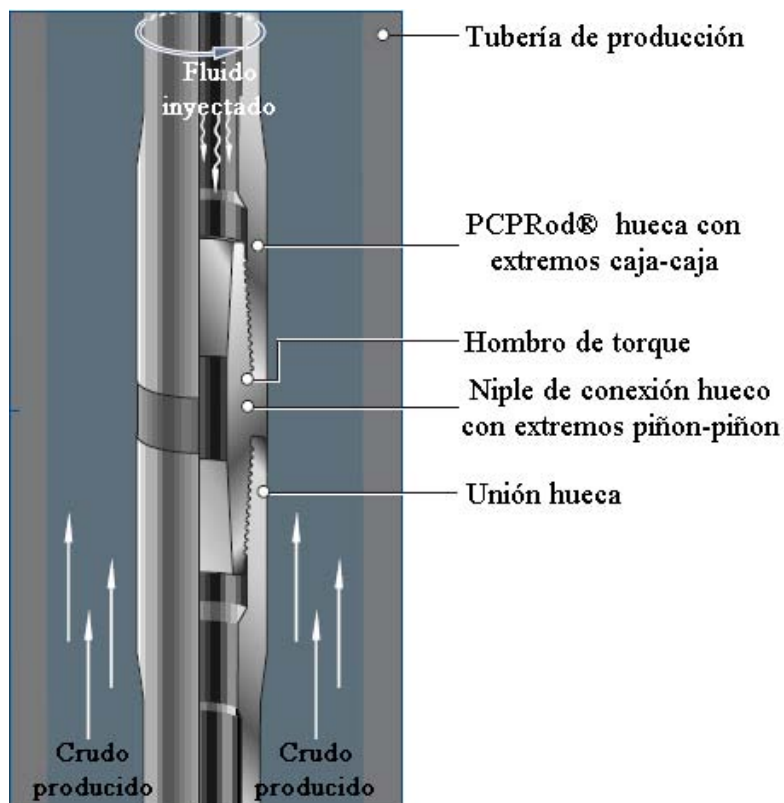
Figura 4.3 Esquema de unión de la PCPRod®.
