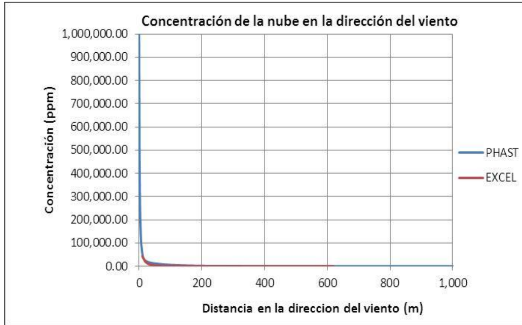
Figura 3.18 Concentración (ppm) en función de la distancia para la liberación de Gas LP de una Pipa. Categoría de 6.5/B.
