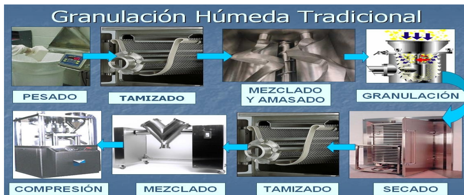
Diagrama 2.2 Diagrama de Proceso de Granulación Vía Húmeda.
