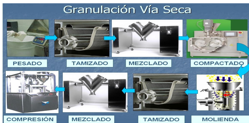
Diagrama 2.3 Diagrama de Proceso de Granulación Vía Seca.
