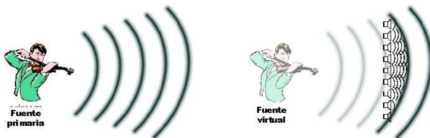
Figura 2.8 Ilustración del objetivo fundamental de la técnica WFS. a) fuente sonora original y su campo acústico; b) campo sintetizado mediante el arreglo de altavoces y la fuente virtual correspondiente.
