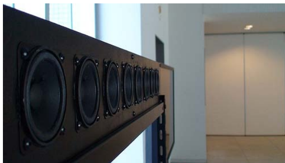
Figura 2.7 Arreglo lineal típico de altavoces en una sala para reproducción mediante WFS. Esta técnica para su implementación requiere de arreglos de un gran número de altavoces.
