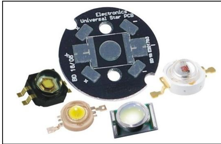
Fig. 3.2.3 Circuito impreso sobre aluminio y LED de alta potencia.
