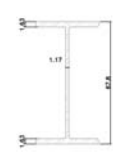
TRABE T-2 W 27"x84 lb/ft R 686x125.6 kg/m ACERO ASTM A-992 CON Fy=3515 kg/cm 2
