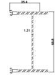
TRABE T-4 W 27"x102 lb/ft R 686x151.9 kg/m ACERO ASTM A-992 CON Fy=3515 kg/cm 2
