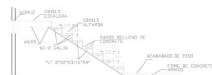
DETALLE ESQUEMATICO DE ESCALERA
