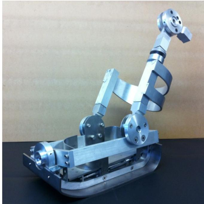
*Ilustración 68. Articulación de pie derecho y eslabón tibio-peroneal.*
