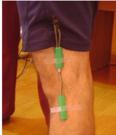
**Figura 30. Instalación del goniómetro.**
