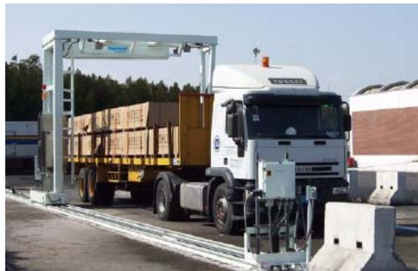
**Figura 4-22** Sistema de Pórtico (*Rapiscan GaRDS Gantry System*)
