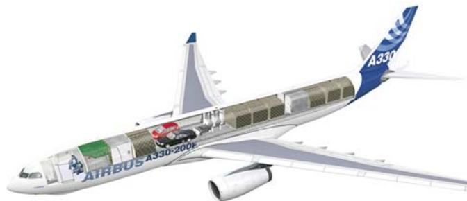
**Figura 7-39** Esquema general de carga del A330-200F
