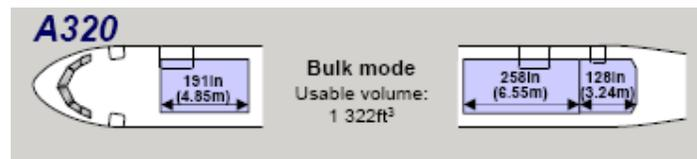
**Figura 7-16** Configuración *Bulk Mode* de un A320
