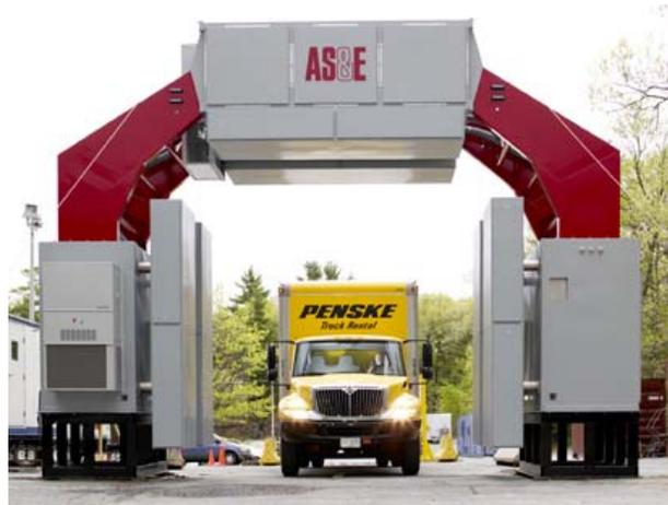
**Figura 4-18** Escáner de rayos X para vehículos
