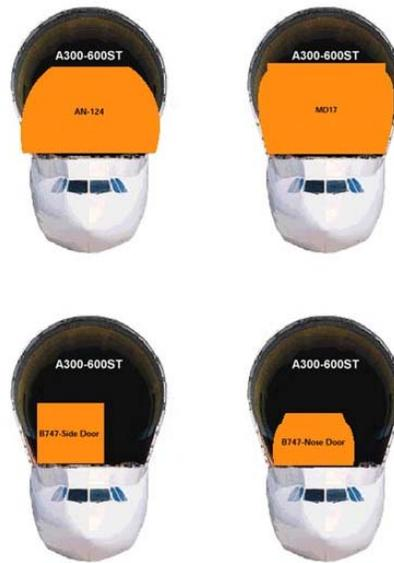
**Figura 7-44** Corte transversal y comparativa del Airbus Beluga
