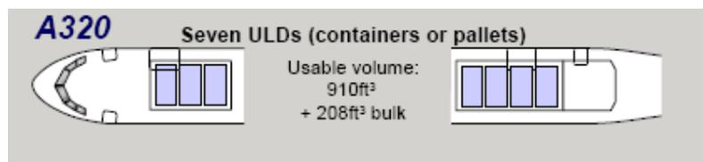
**Figura 7-17** Configuración *Uld Mode* de un A320
