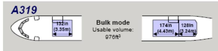
**Figura 7-9** Configuración *Bulk Mode* de un A319
