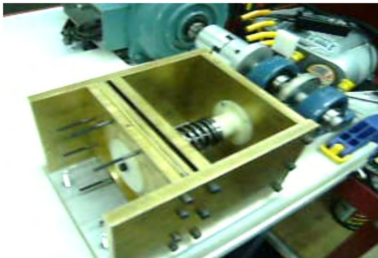
Figura 4.5 Prueba del sistema de accionamiento con la configuración émbolo-membrana.
