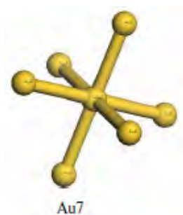
Figura 1.1 Ejemplo de configuración de equilibrio para el cúmulo Au 7 .
