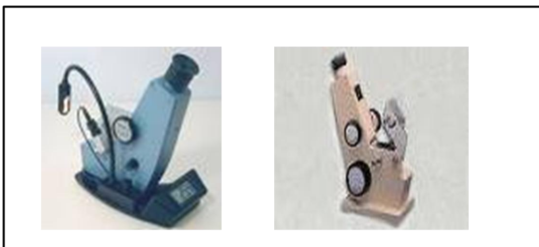
Fig. No. 4 Equipo para la determinación de índice de refracción Refractómetros Abbe Fuente: http://www.pce-group-europe.com
