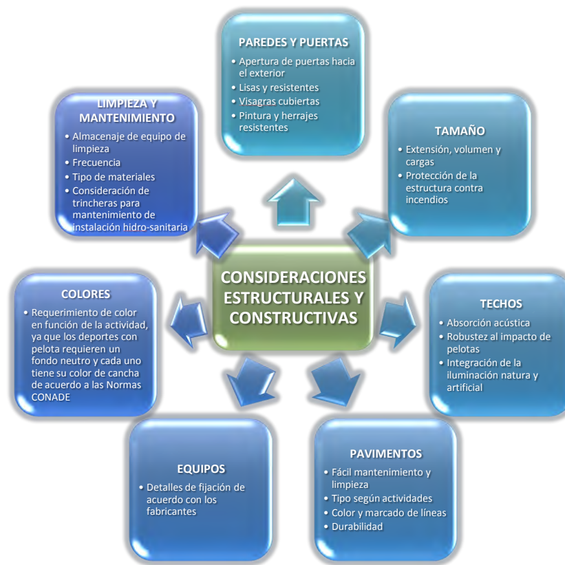
DIAGRAMA DE CONSIDERACIONES ESTRUCTURALES Y CONSTRUCTIVAS
