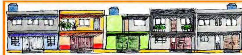
Tipología 2: (Predomina en la colorida, compuesta por viviendas de la segunda etapa de construcción de los procesos de evolución de la vivienda A y B) Llano y vacío en equilibrio; construcciones de dos niveles, ventanas rectangulares en ambos niveles. Marquesinas en planta baja usadas para colocar plantas en recipientes o como espacio ganado al construir sobre las banquetas. Los colores presentes en las fachadas son rojos, verdes y azules, predominando el color gris del tabicón con que están construidas las viviendas.
