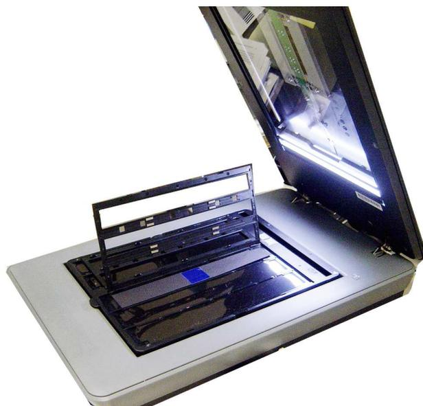
Figura 3.6: Fotografía del escáner HP G4050 usado para digitalizar las películas.
