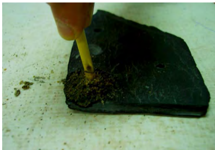
IMAGEN N. 50 Experimento. Perforación con carrizo y abrasivo de arena de cuarzo con agua.
