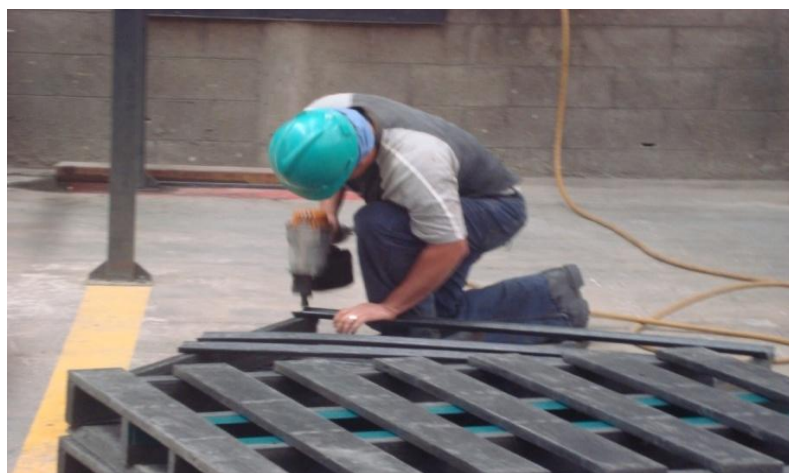
Fig. 20 Ensamble de las piezas de tarima
