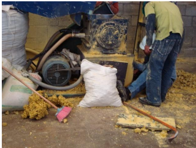
Fig. 57 Falta de limpieza en maquinaria
