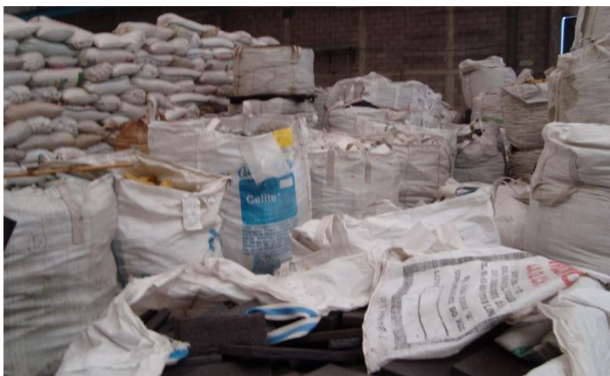
Fig. 27 Fotografía en donde se muestra que no hay clasificación de los materiales y tampoco pasillos en el área de almacén de materia prima.
