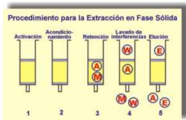
**Figura 7:** Pasos para la activación del cartucho de EFS o SEP
