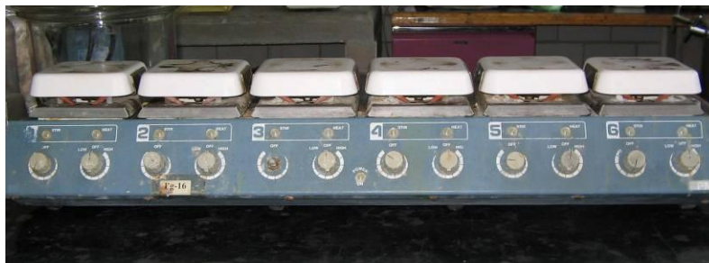
Figura 3.3. Parrilla eléctrica empleada para desgasificar y digerir la muestra
