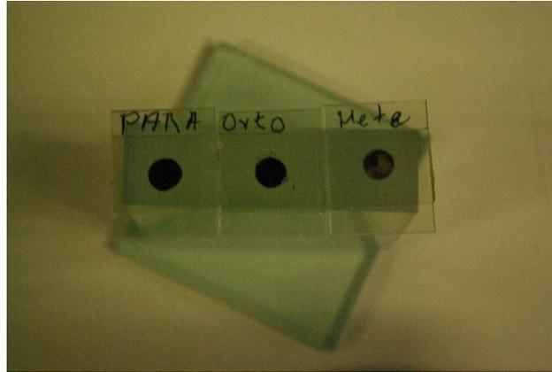
*Figura 3.4.1.1.a. Fotografía que ilustra las celdas empleadas para determinar las propiedades eléctricas de las muestras de los compuestos 4a y 4b.*
