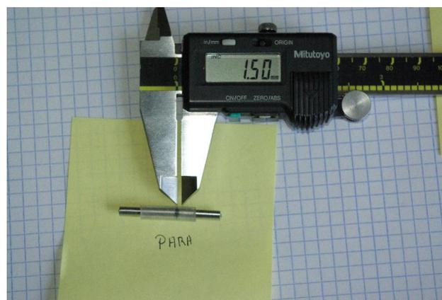
*Figura 3.4.1.1.b. Fotografía que ilustra la celda fabricada para determinar la impedancia de la muestra del compuesto 4c.*
