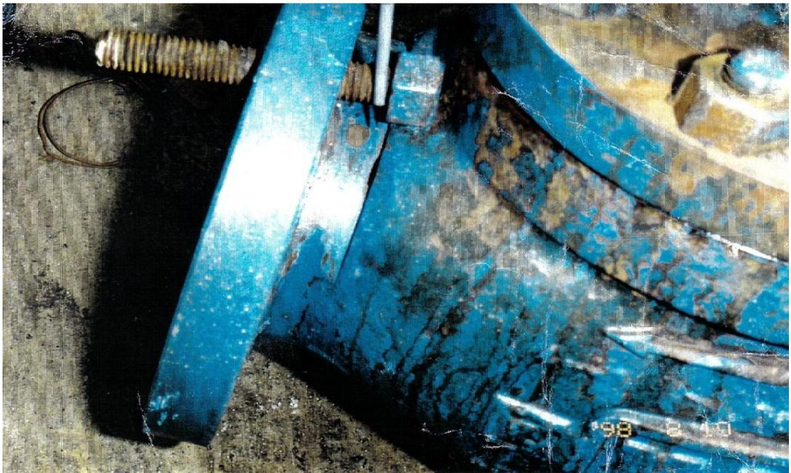
Válvula de paso de gases condensadores de máquina para la fundición de aceros "Aceros de México" año 1998, la zona amarilla de los tornillos muestra las áreas de oxidación causadas por los ácidos alcalinos que fueron formándose en el interior del mismo.
