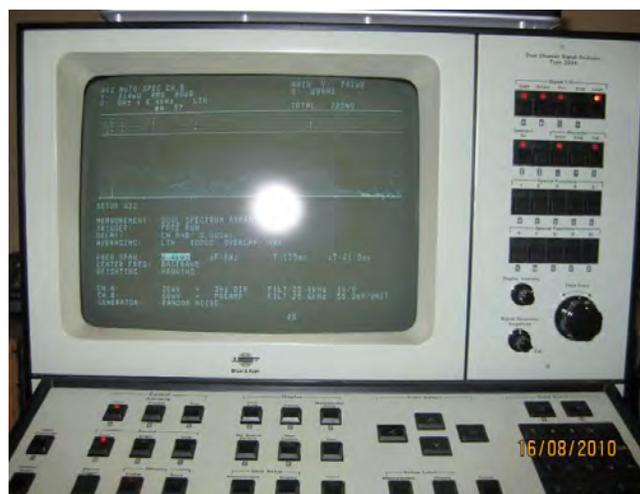
Figura 5.41: Analizador de Espectros utilizado
