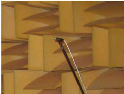
Figura 5.42: Micrófono de medición.
