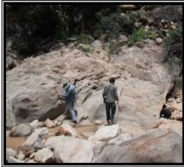
Figura 1.2. Medición de la columna estratigráfica utilizando el Báculo de Jacob, en el río Numí
