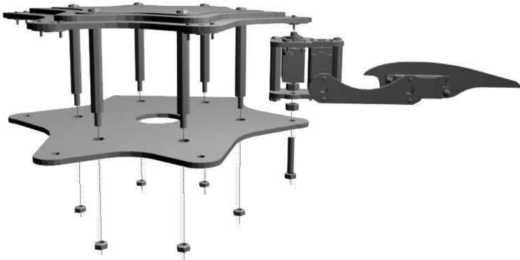
Figura 28: Unión de la pata al cuerpo
