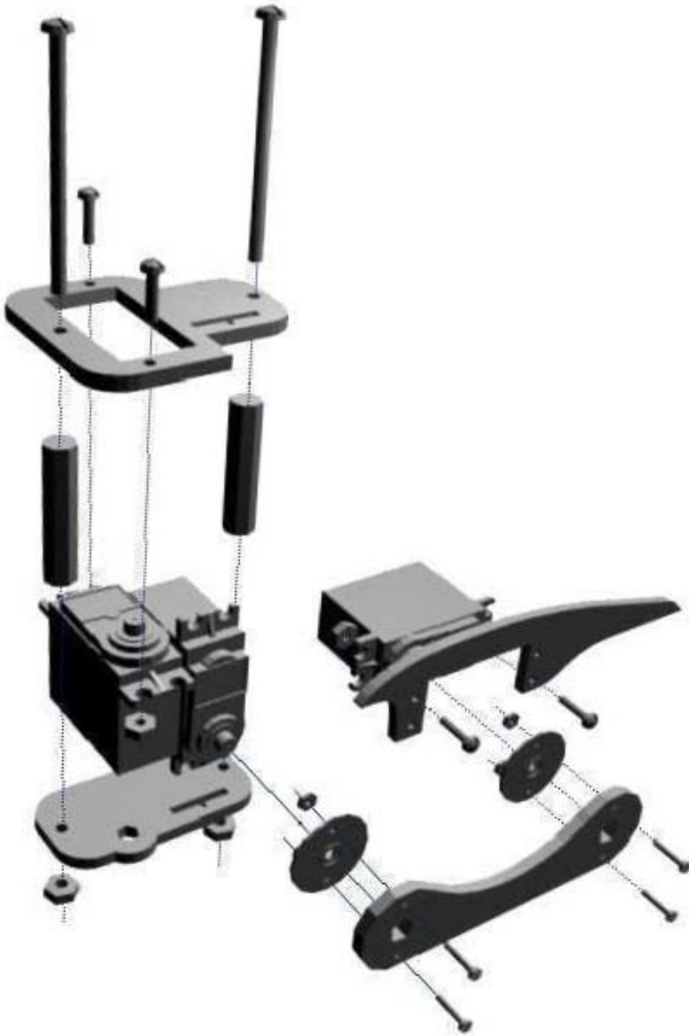
Figura 26: Ensamble completo de una pata
