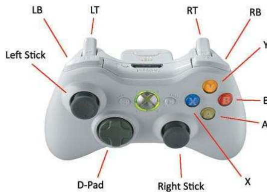
Figura 60: Control de Xbox 360 utilizado para manejar el robot
