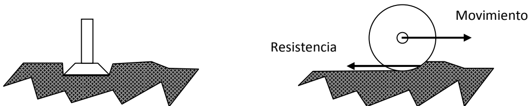
Figura 7: Deslizamientos en un robot móvil [11]
