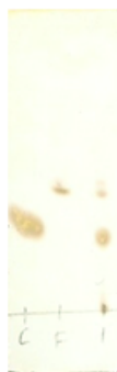
Placa 4. Determinación cualitativa de Ap-C y AF en extractos obtenidos con Acetato de etilo, de izquierda a derecha: estándar de Ap-C, estándar de AF y muestra
