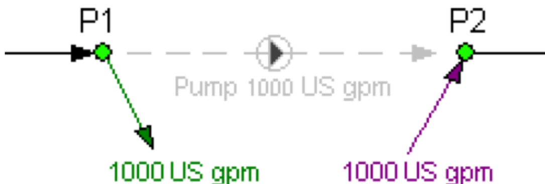
Figure 2.8. Reemplazo de la Bomba de Caudal Fijo.
