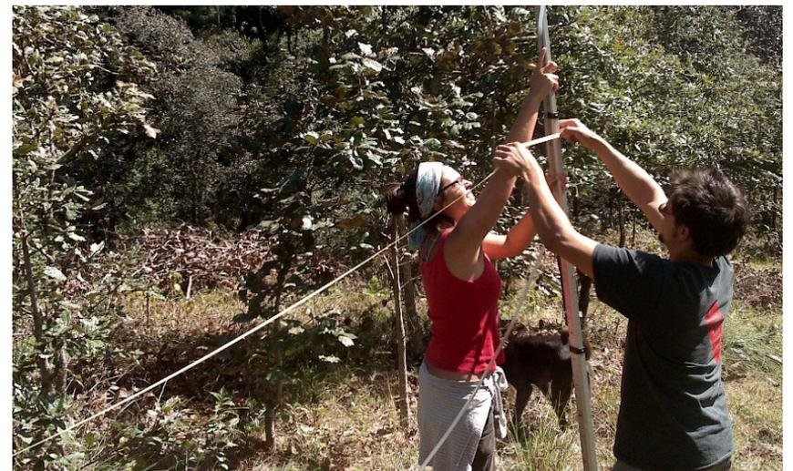
Figura 100 y 101: Sacando cotas de curvas del terreno con la manguera y regla . Fuente: Propia del autor
