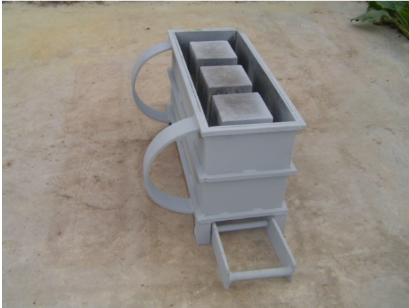
Foto 53; Molde de bloquera para fabricación de block hueco de 15x20x40 cm
