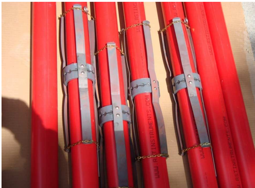
Fig. 9 Arañas magnéticas en tubería para inclinómetro.
