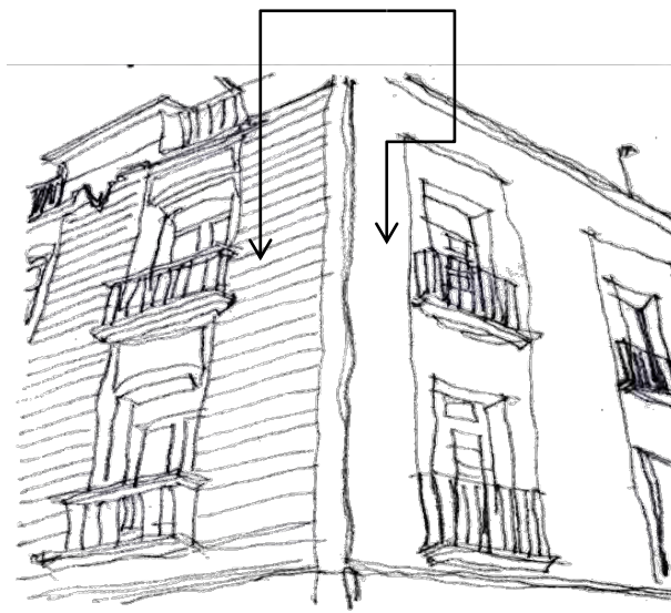
•Discontinuidad en la transición de acabados en fachadas de un mismo edificio 107 Perímetro de estudio / Colonia Guerrero. Imagen: Javier Angel Santamaria Cruz-Julio César Vilchis Muñoz © 2010.
