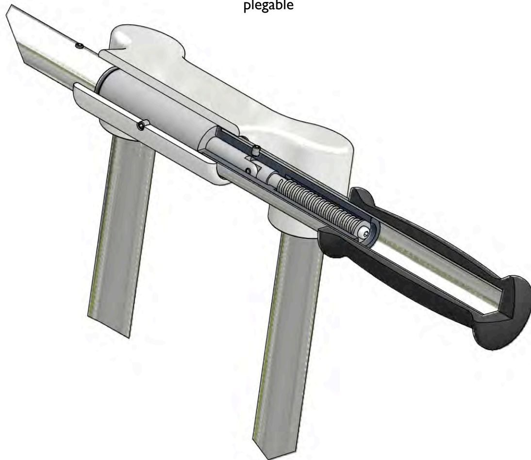
Detalle en corte del manubrio plegable
