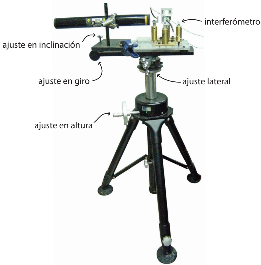
Figura VI.2 Montura del interferómetro sobre el tripié empleado.
