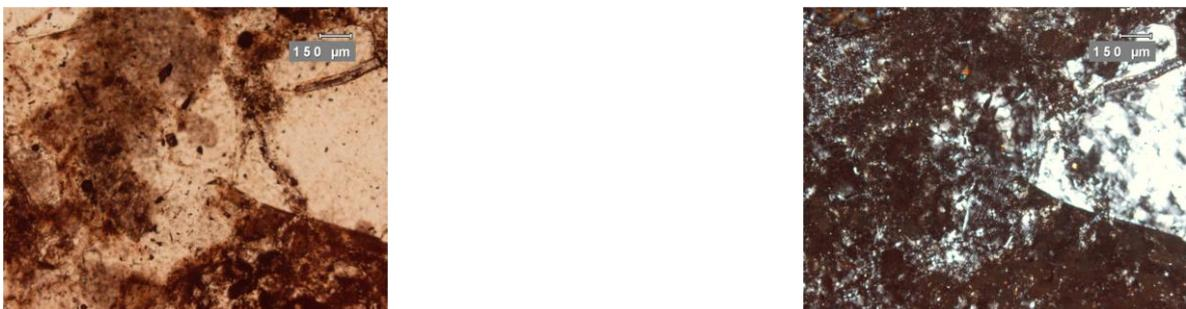
Figura 35. Unidad Las Paredes, muestra LP-14 (imagen izquierda luz paralela e imagen derecha nicols cruzados). Ignimbrita vitroclástica moderada a fuertemente soldada, con bajo contenido de cristales. Se observan fragmentos de vidrio en matriz vítrea soldada.
