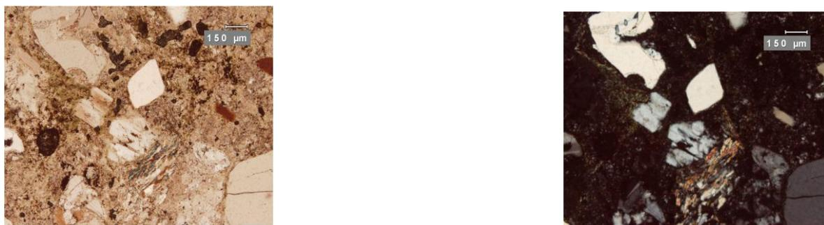
Figura 21. Unidad Torrecillas, subunidad 1, muestra LP-01 (imagen izquierda luz paralela e imagen derecha nicoles cruzados). Ignimbrita pobremente soldada y rica en cristales. Fenocristales de cuarzo, sanidino y plagioclasa.
