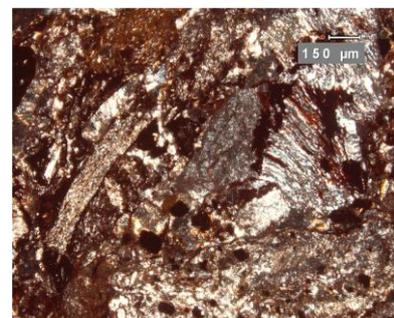
Figura 14. Dique andesítico-basáltico, muestra D-1 (imagen izquierda luz paralela e imagen derecha nicoles cruzados), con fenocristales de piroxeno y plagioclasa, matriz pilotaxítica con componente principal de plagioclasa.
