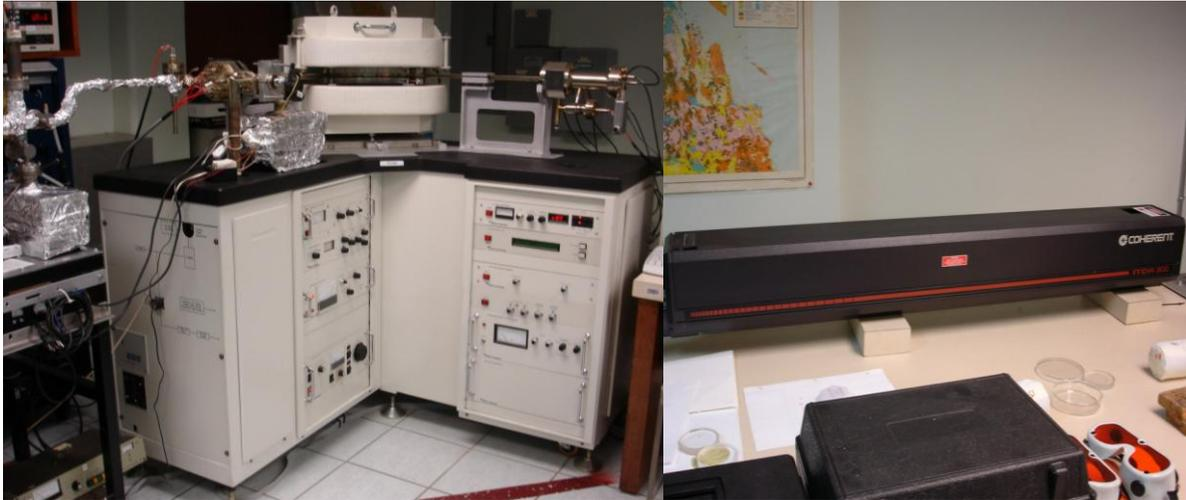
Figura 46. Espectrómetro de masas VG5400 (izquierda) y láser Coherent Innova 300 (derecha).
