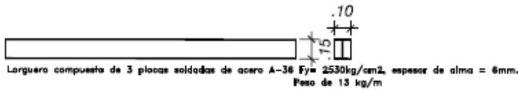
Detallamiento de las Vigas Interiores de Edificio Tipo
