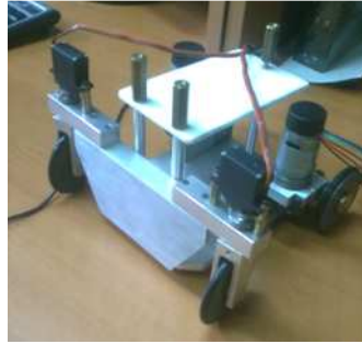
Figura 20. Vehículo piloto con sistemas Steer By Wire y Differential Drive .
