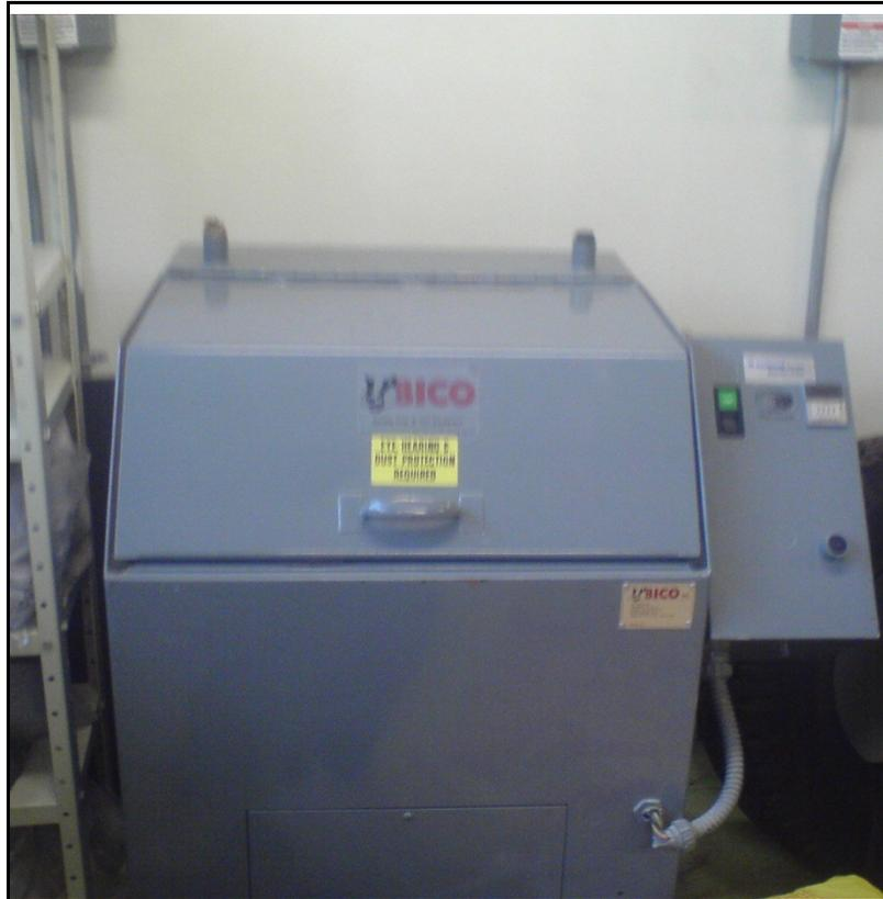
Figura 2.1. Mortero de anillos marca Rockwell.
