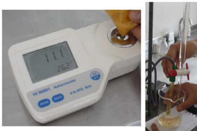
**Figura 13. Refractómetro digital y titulación potenciométrica.**
