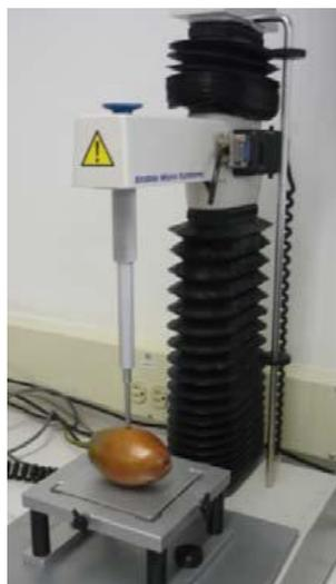
Figura 12. Texturómetro TA.XT2i
