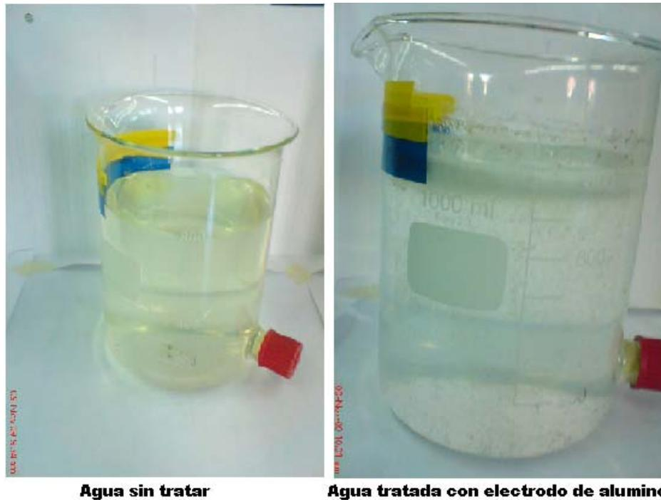
Figura 4.3 Comparación del agua tratada con electrodo de aluminio y antes de ser tratada.
